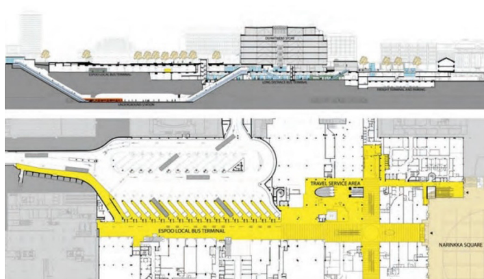
Рис. 2. Проект Каппи Центра. Разрез наземной и подземной частей комплекса. План здания второго подземного уровня с выделением общедоступного пространства (желтый цвет)
