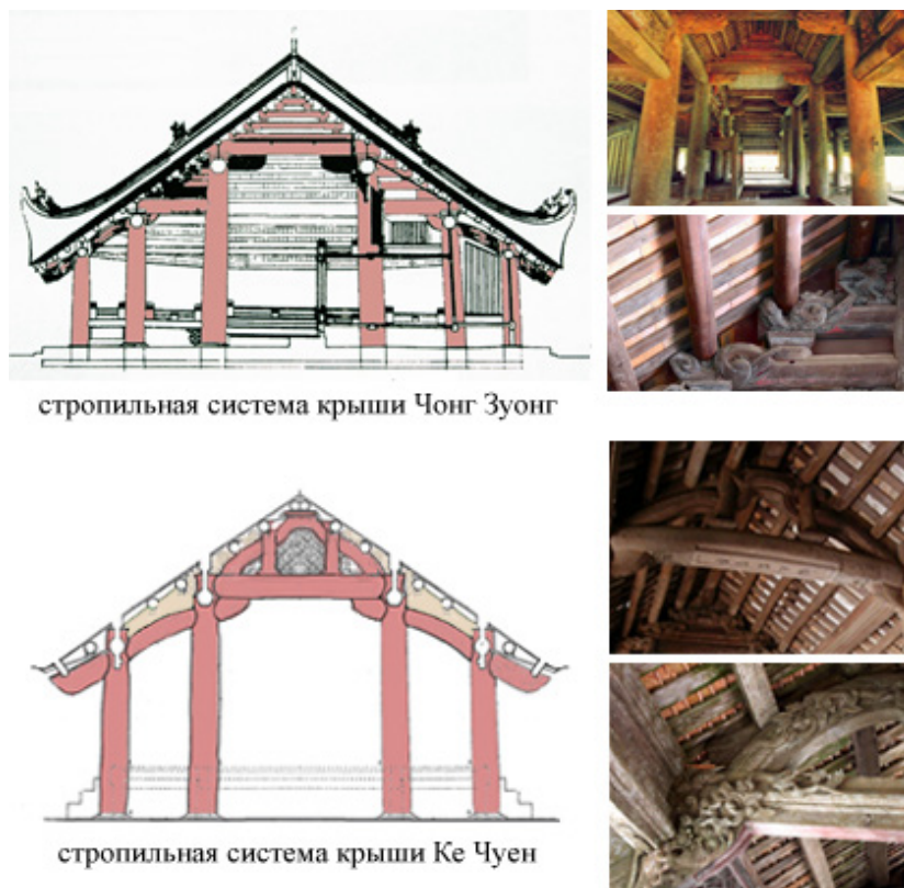
Рис. 7. Стропильная система крыши динь
