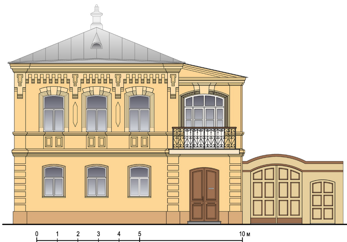
Рис. 3. Главный фасад дома в начале XX в. Графическая реконструкция автора на основе натуральных изысканий и фотографии 1911 г. из фондов Астраханского музея-заповедника [9]
